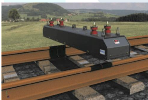
Slika 5. Uređaj za mjerenje profila tračnice uređaj(izvor:apps.unizg.hr)
