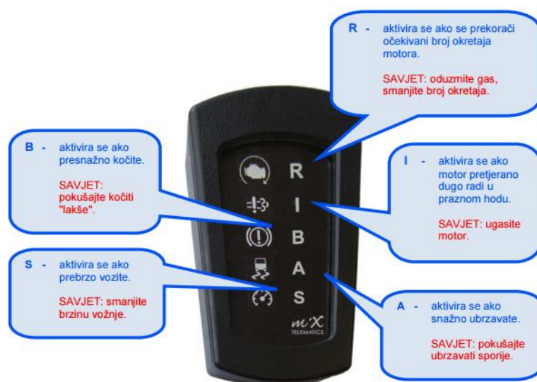
Slika 4. Funkcije panela RIBAS
