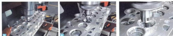
Glodnje sjedišta, vađenje ostatka sjedišta i obrada otvora za novo sjedište
