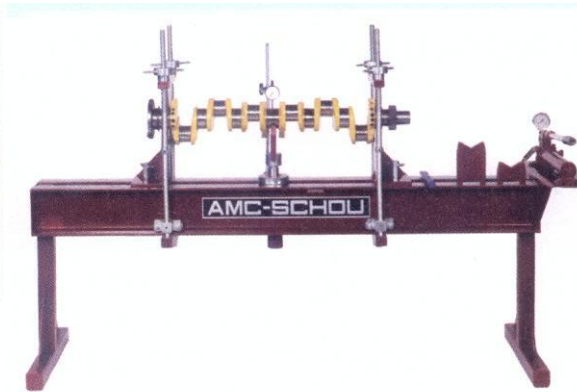
Stroj za kontrolu pravocrtnosti i za ispravljanje koljenastog vratila
