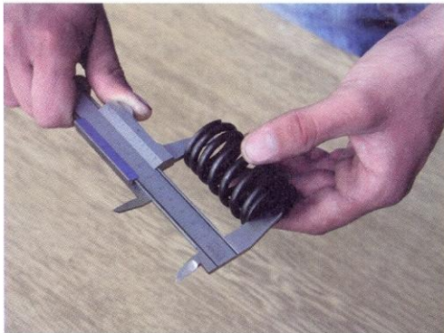
Mjerenje duljine opruge u slobodnom stanju
