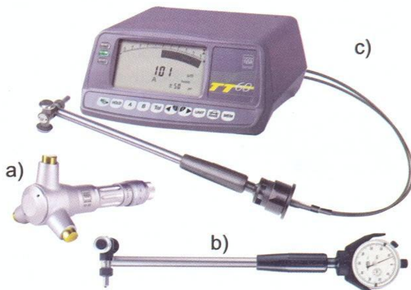
Instrumenti za unutarnja mjerenja: a) mikrometar, b) mehanički komparator, c) elektronički komparator
