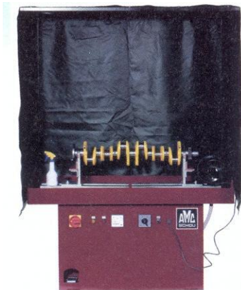
Uređaj za otkrivanje pukotina u koljenastom vratilu ultravioletnim zrakama
