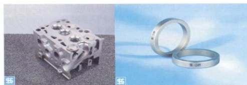
Presjek glave motora i nova sjedišta ventila
