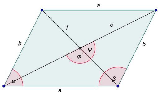
Označimo s  $a$  i  $b$  duljine stranica paralelograma,  $e$  i  $f$  duljine dijagonala,  $\alpha$  i  $\beta$  mjeru kutova paralelograma, a  $\varphi$  i  $\varphi'$  mjeru kutova između dijagonala paralelograma.
