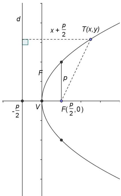
Tjeme  $V$  raspolaže udaljenost od fokusa do direktrise. Ta je udaljenost jednaka poluparametru  $p$  parabole. Zato su koordinate fokusa  $F\left(\frac{p}{2}, 0\right)$ , a jednadžba direktrise  $x = -\frac{p}{2}$ .
