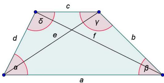
Označimo s  $a, b, c$  i  $d$  duljine stranica trapeza,  $e$  i  $f$  duljine dijagonala,  $\alpha$  i  $\beta$ ,  $\gamma$ ,  $\delta$  mjere kutova trapeza.
