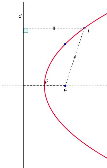
**Parabola** je skup svih točaka ravnine koje su jednakom udaljenom od jednog čvrstog pravca  $d$  i jedne točke  $F$  u toj ravnini koja ne leži na tom pravcu.
