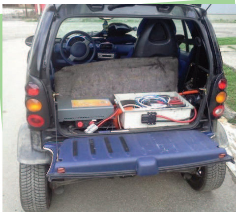
Smještanje kontrolera, pretvarača, punjača i baterija u prtljažni prostor
