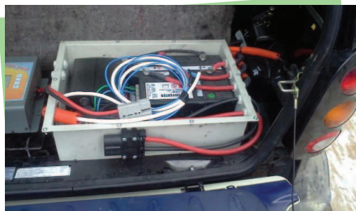
Povezivanje strujnim vodičima velikog presjeka
