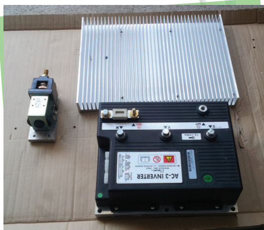
Kontroler, hladnjak i glavni sklopnik spremni za ugradnju
