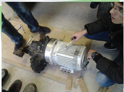
Mjenjačka kutija s elektromotorom spremna za ugradnju u automobil
