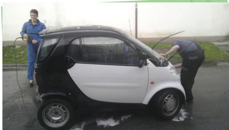
Pranje i odmaščivanje prije vraćanja dijelova vanjske oplata
