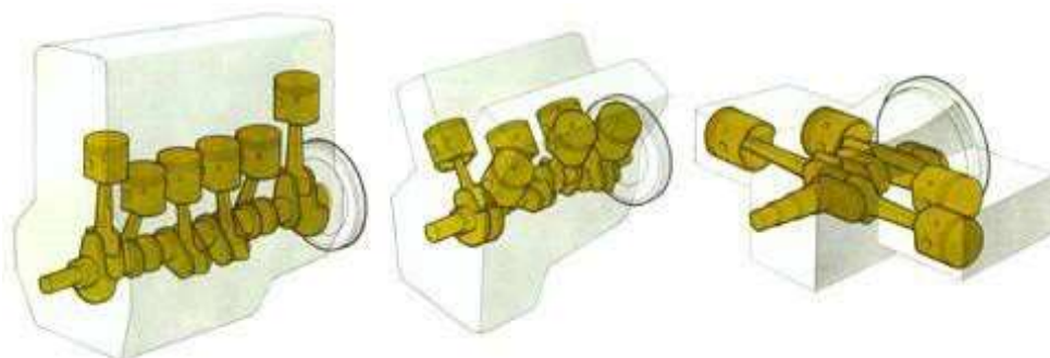
Razne izvedbe bloka motora s obzirom na broj i položaj cilindara – redni, V i bokser
